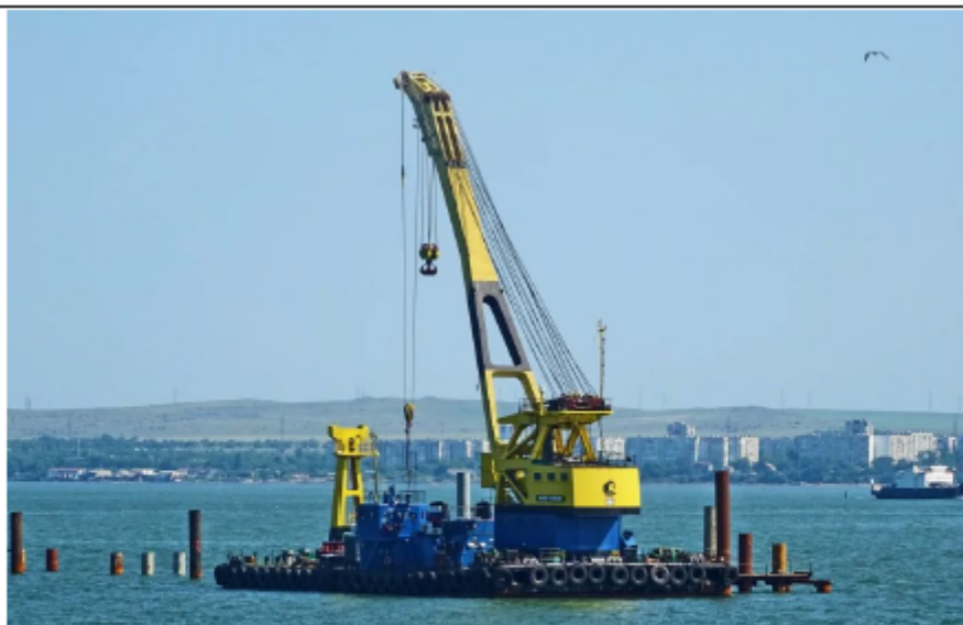
Морской самоходный плавкран типа Черноморец 100т
